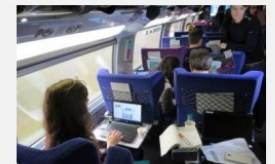
À partir de décembre 2016, les TGV de la ligne Paris – Lyon sont équipés d'émetteurs Wi-Fi : ceux-ci émettent des micro-ondes permettant aux ordinateurs des voyageurs de se connecter à Internet.
