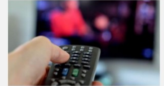
Les télécommandes courantes « communiquent » avec la télévision à l'aide d'un rayonnement infrarouge.
